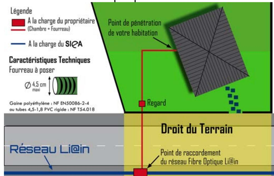
Le point de raccordement du réseau Fibre Optique Li@in peut aussi être en aérien. Dans ce cas, le point de raccordement sera situé au pied d'un poteau.
